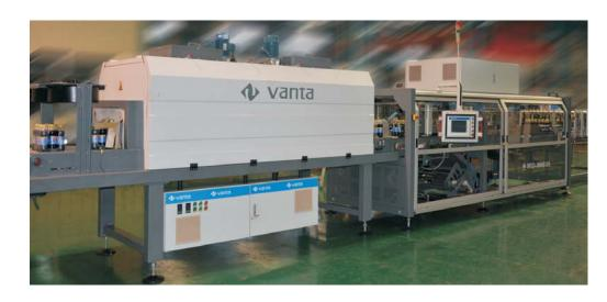
MMB系列由多个全自动机型组成,可以包装以塑料、金属或玻璃为材质的容器。
