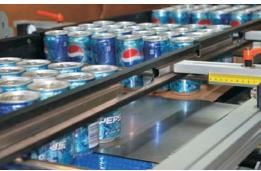
这是一个特别精巧的系统。热收缩膜被送到产品组底部的前端,缠绕棒带着热收缩膜在容器组进入收缩炉之前完成对产品的包裹。
