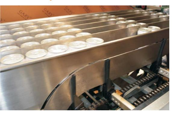
分瓶方式采用塑料分瓶指,国内同行纸膜包机一般采用的是钢之类的金属分瓶指,塑料指比金属指更耐用,同时降低了机器的噪音,能保护易损的容器(如玻璃容器)和避免商标磨损。
