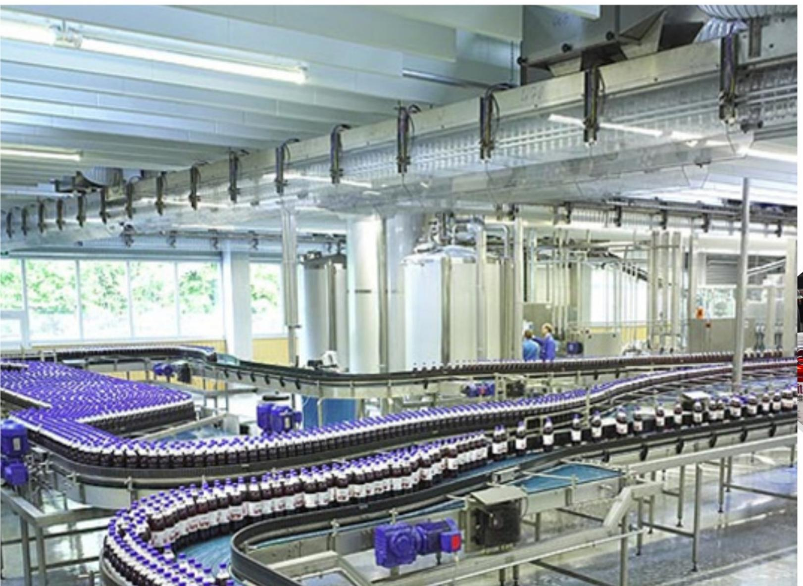
饮料生产线的输送设备，包括：瓶胚的输送、瓶盖的输送、空瓶的输送、实瓶的输送、后段包装物的输送等。
